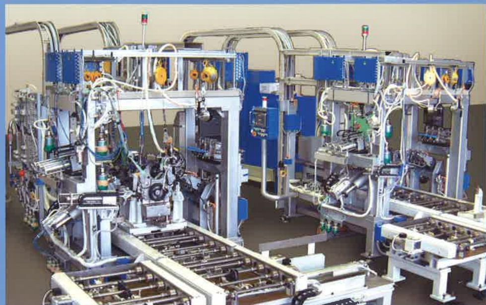
エンジンコールドテスト工程 Engine Cold Test Station
